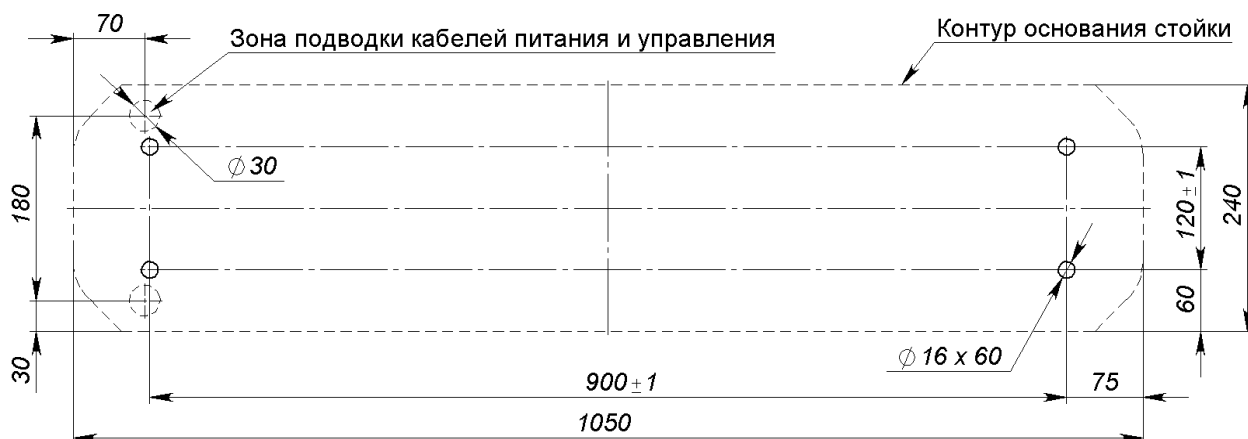
Рисунок 6 — Схема разметки для установки стойки КТС01.3
